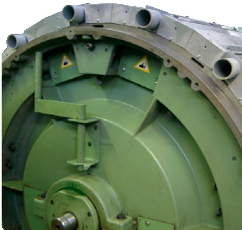
**SD**, Sistema de chapones fijos para cardas Trützschler a partir de la DK 715 y cardas Rieter a partir de la C1/1
