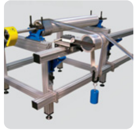
Instalación de guarniciones flexibles
